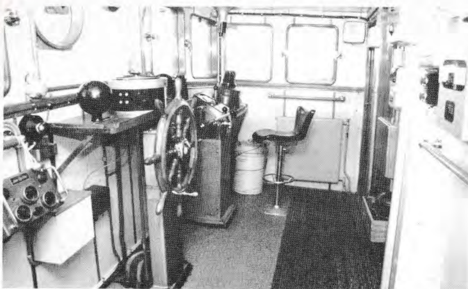
«Nordsyssel» var meget godt utstyrt, bl.a. VHF-, SSB- og mellombølgeradio, radiipeiler, 2 sett radar, ekkolodd, selvstyring, magnet- og gyrokompass. Foto: Tore Wassbakk.
