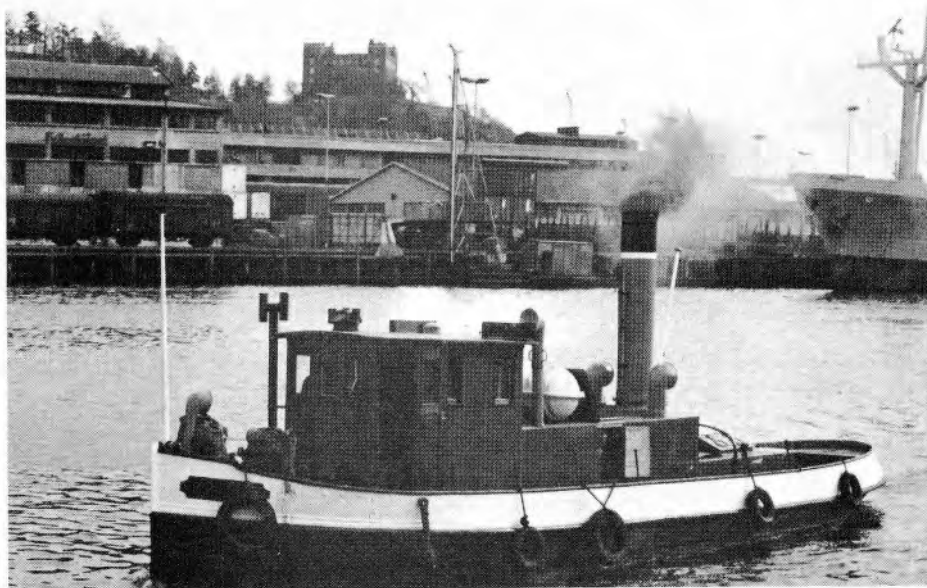
Kullfyrte D/S «Pasop» på Oslo havn. Bygget ved Glommens mek. Verksted i 1908, 43 fot lang, 10 fot bred. En Compounder på 38 IHK gir båten 7 knops fart.
