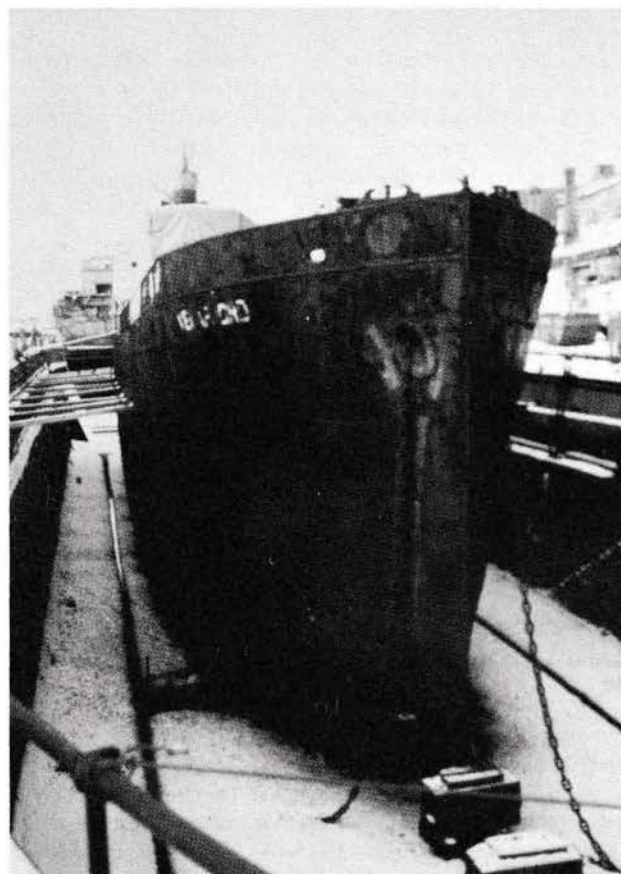
D/S «Hestmanden» i dokk på TVM for reparasjon og konservering av skroget. Første inspeksjon avslørte en rekke defekte nagler. Disse må oppklinkes før skipet bringes flott.
