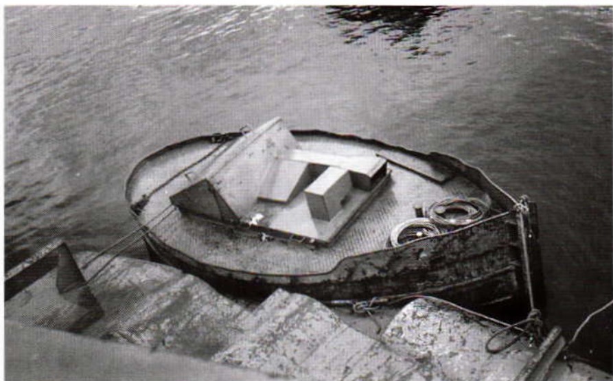
Konstruksjonen heter traktorbåt og brukes til jobbing i lensene.
