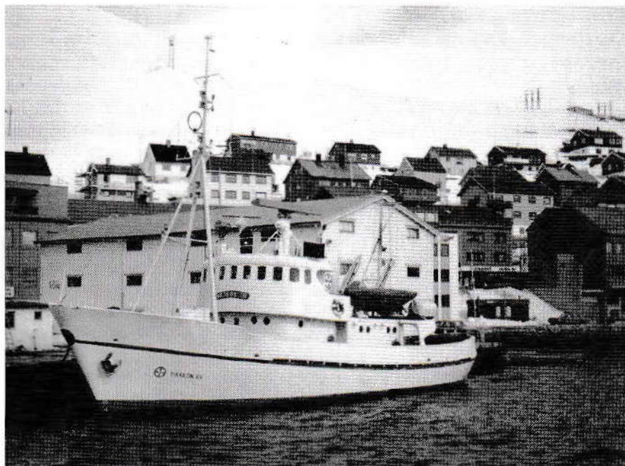
R.K."Haakon VII", Redningsselskapets nye flaggskip. Hovedmaskineriet er en MWM-motor som gir 525 BHK. Det er hyggelig innredning for 7 mann og dessuten en stor lugar for skibbrudne.
