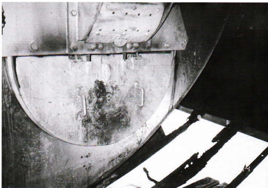
«Styrbjørn» – fyrgang B/B med dårlige spant.
