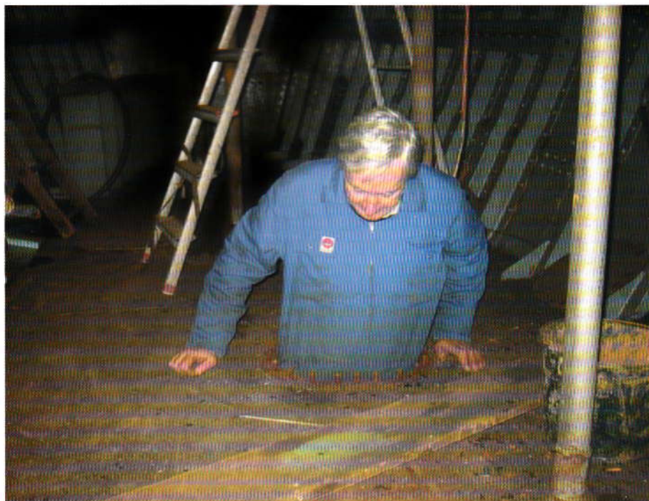
Lars Hille tester om kroppen passer til mannlokket på kjelevannstanken.
