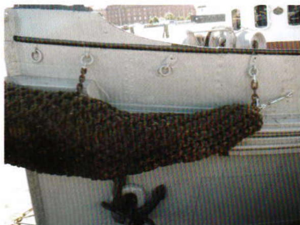
På Gotenius Varv fikk D/S "Styrbjørn" montert ny baugfender.
