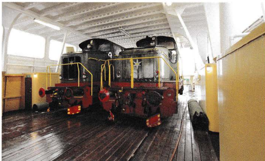
90 tonn. To lokomotiver er på plass som ballast.
