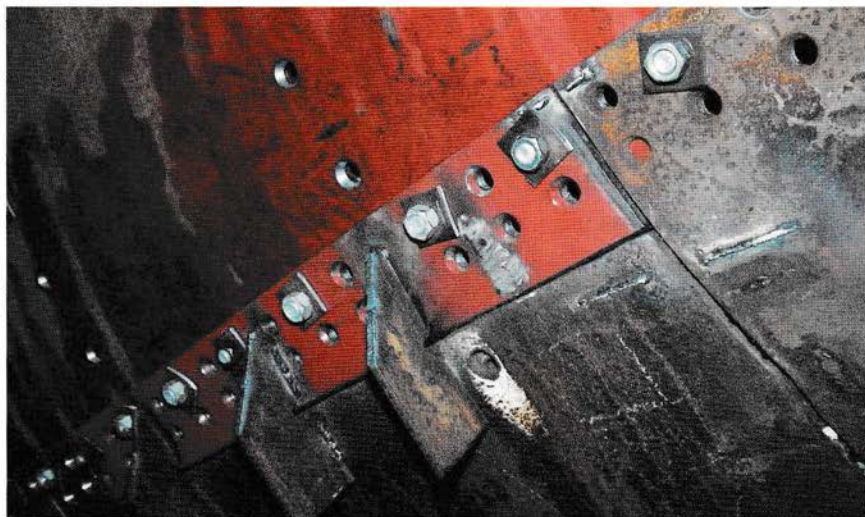
Plateutskiftning i skroget, Et mindre stykke av nedre plate felles inn med sveis. Platesømmene for øvrig klinkes.
