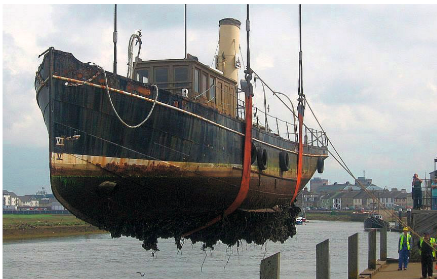
Gjennomtenkte planer for vedlikehold er helt nødvendige i et bevaringsprosjekt. Dampyachten «Carola» fra 1898 løftes på land for svært påkrevet vedlikehold.
