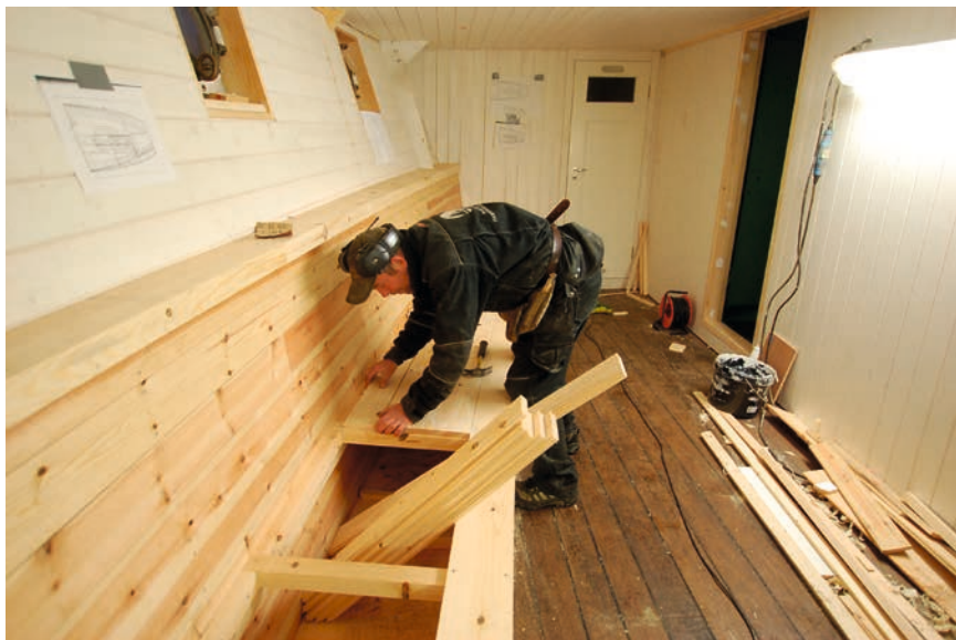
Arne Jostein Jensen er snekker og båtbygger og har vært det meste av innredningsjobben på Stord. Her er han i sving med kistebeinkene i 2. plass herresalong.
