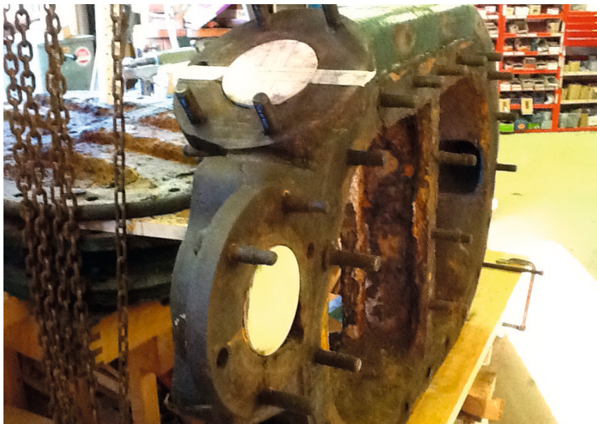
Slik så aktre vannkammer ut, med store rustskader.
