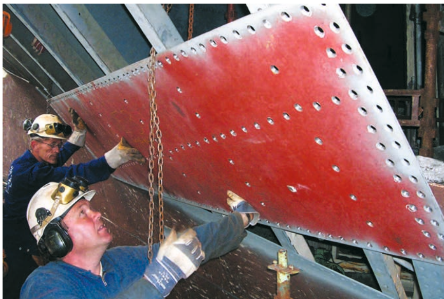
Skifting av hudplate på skoleskipet «Sørlandet» på Bredalsholmen. Denne verkstaden er ein del av den infrastrukturen fartøyvernet treng. Dette biletet er også frå «Nasjonal verneplan for fartøy 2010–2017. Foto: Bjørn Nesdal, Bredalsholmen dokk- og fartøyvernssenter.
