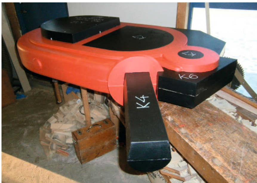
Modellen til aktre vannkammer. Det røde blir støpejern, mens det svarte er «anvisere» som holder kjernene på plass.
