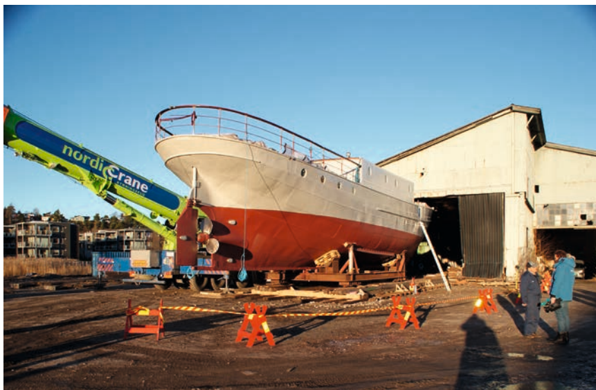
«Hvaler» ute i friluft for første gang på mange år. Vi ser tydelig transportvogna med hjørnestøttene.
