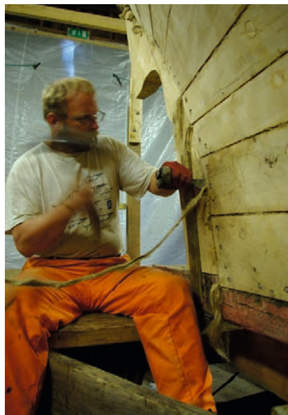
Båtbygger Håkon Danielsen på Bragdøya driver skroget på risørskøyta «Pil». Driving av skrog og dekk er viktige vedlikeholdsarbeider.
