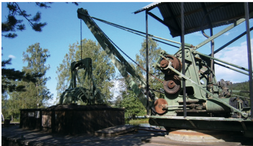
Mudderapparatet med grabben stående på overbygget på lekteren.
