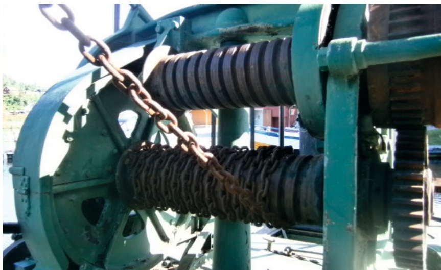
Winchen har to kjettingtromler, en for senking og åpning, en annen for lukking og samtidig heving. Her er bare den ene i bruk. Foto: Bjørn Anderssen
