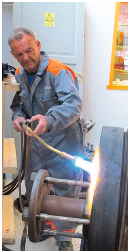
Oppvarming av svinghjul for tersing. Håkon Kvarven
