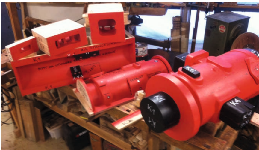
Støpemodellen til ny sylinder som skal erstatte den på forrige bilde. Den er nå klar for å sendes til støperi.
