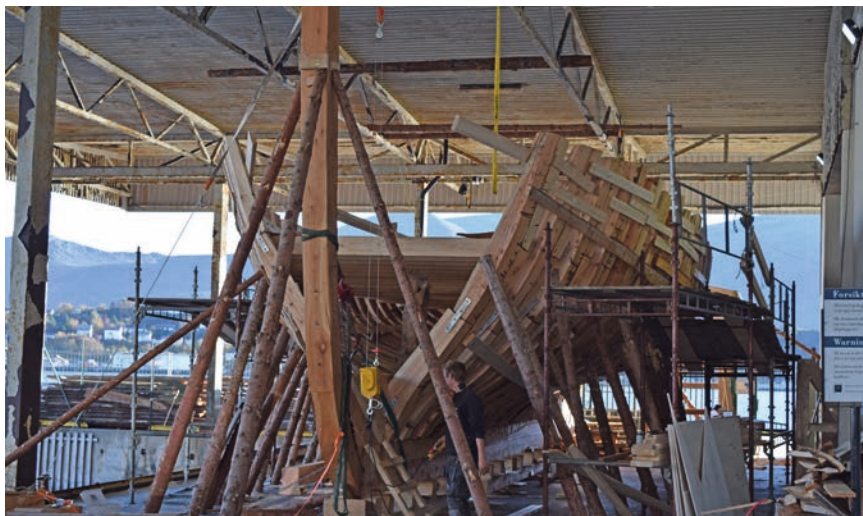
Oppspantingen er godt i gang. Vi ser tydelig hvordan de doble spantene bygges.
