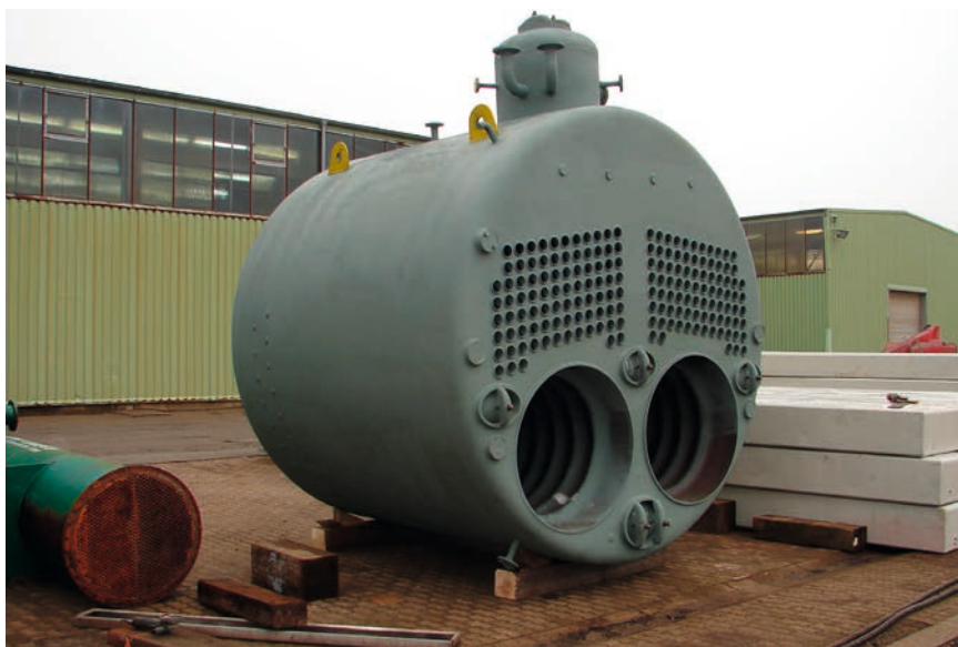
Den nye kjelen klar på kaikanten. Med mål som den gamle, men med sveisesømmer i stedet for naglerader. Kullfyringen er beholdt.
