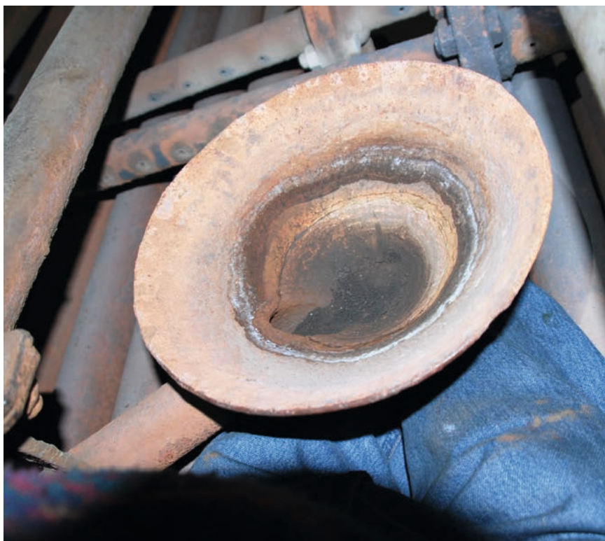
Bildet viser skummetallerkenen i kjelen på «Oster».
