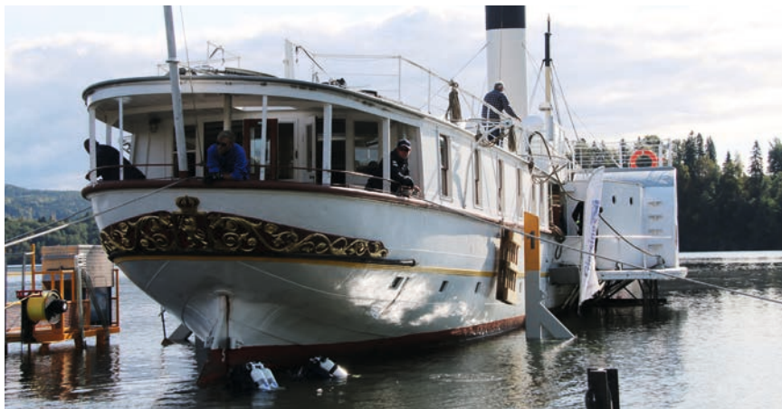
Akterenden ligger an på slippvogna. For sikkerhets skyld kontrollerer dykkere at plasseringen er riktig.
