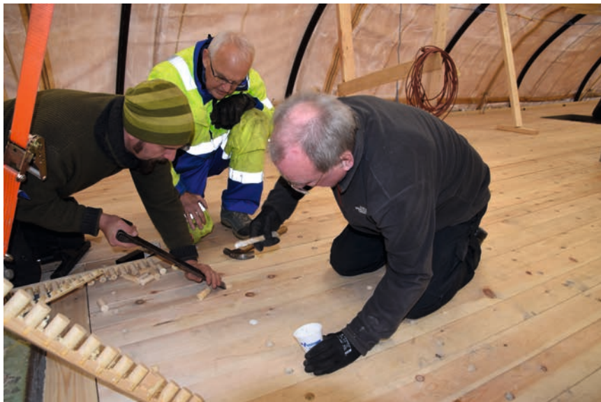
Slik skal karpuner (treplugger) settes i borehullene. Endre Lund fra Gratangen Fartøyvernssenter forklarer for Knut Karstad og Håvar Gabrielsen fra Skogøys venner.
