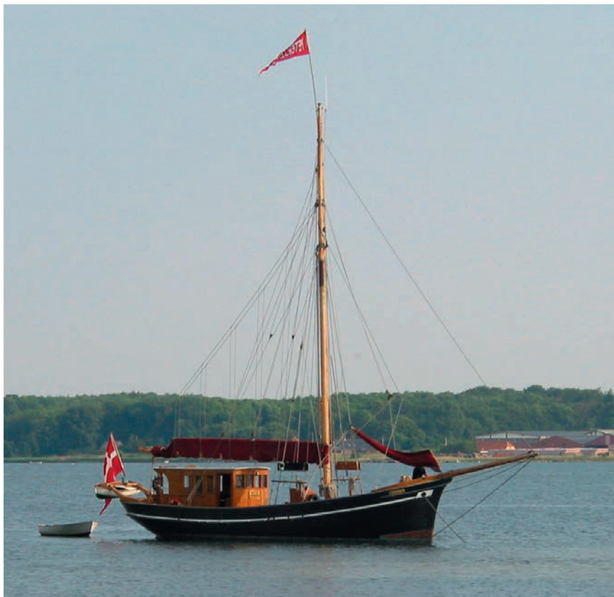
«Emma», bygget om motorkutter i 1931. Originalt skrog, ombygget til fritidsformål med teakdæk, stort styrehus og uoriginal rigning. Klasse D.
