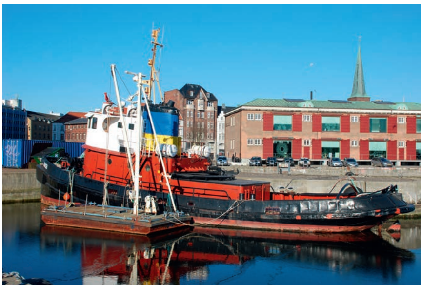
«Jakob», bugserbåd bygget i Texas i 1943. Danmarks ældste, helsvejsede skib. Oprindeligt skrog, nænsomt moderniserede styrehus og kamre. Bugserkrog og spil er fjernet for at give plads til passagerer på dæk. Klasse B.
