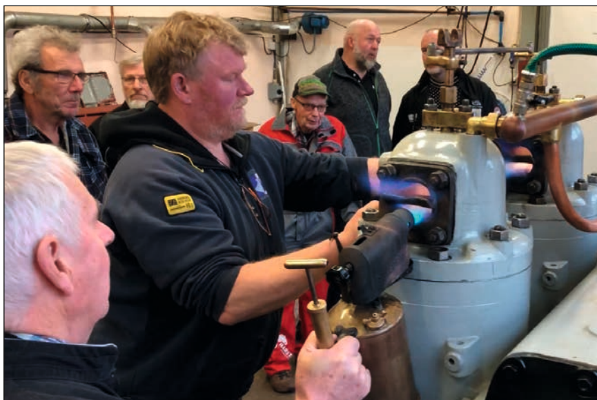
Her fyrer Jann Sandøy (til venstre) og Sverre J. Lund opp hver sin sylinder ved hjelp av fyrlampe. De forvarmer toppene på en 2 sylindret Wichmann 35-45hk, antagelig fra 1934. Dette er en 2-takts oljemotor (diesel), og tilhører fartøyet «Stangfjord».
