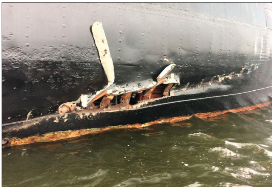
Flengen i skroget til «Stettin». Foto fra undersøkelsesrapporten til BSU.
