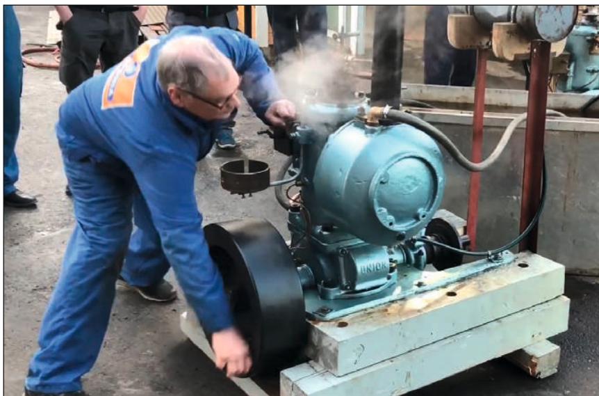
Konrad P. Hansen som starter en 7,5 hk Union. Motorer av denne størrelsen ble i hovedsak brukt i fartøyer på mellom mellom 20 og 35 fot.
