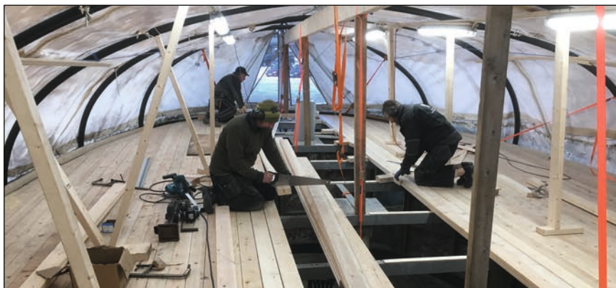
Endre Lund fra Nordnorsk Fartøyvernssenter og Morten Hesthammer fra Hardanger Fartøyvernssenter legger dekkspalter på båtdekket om bord i «Skogøy». I bakgrunnen Martin Skårstad fra Skogøys venner. Foto: Skogøys venner
