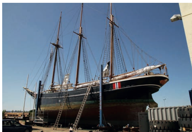
Slippsetting er av de store regelmessige vedlikeholdsoppgaver. Foto: Øyvind Christoffersen
