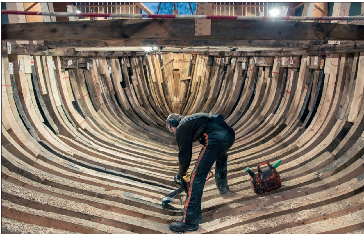
«Fremad II», fra 1888 har en fortid som engelsk fiskekutter, fra 1905 som norsk, og som Shetlandsfarer under krigen. Som Norges eldste fiskefartøy trenger hun omfattende restaurering - de fleste spantene ble byttet ut. Foto: Silje Ensby
