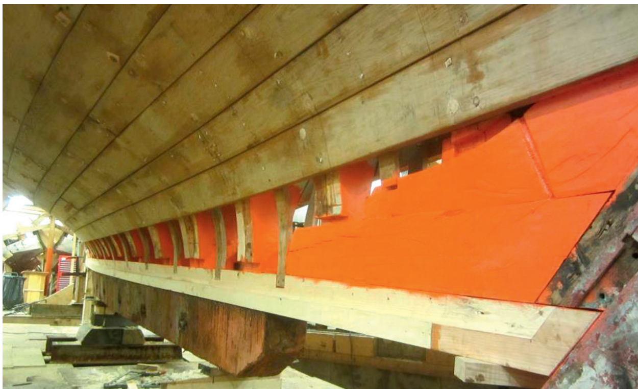
Ny trekjøl og øvre del av jernkjølen er på plass i lykkelig gjenforening. Foto: Risør Trebåtbyggeri
