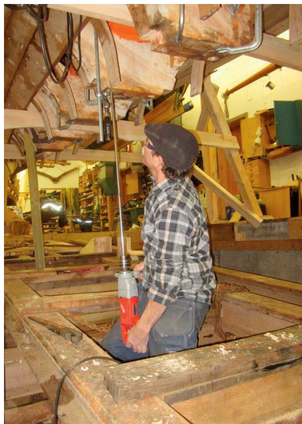
Mens skroget er løftet opp borer Charles Beasley hull for kjølboltene. Foto: Risør Trebåtbyggeri
