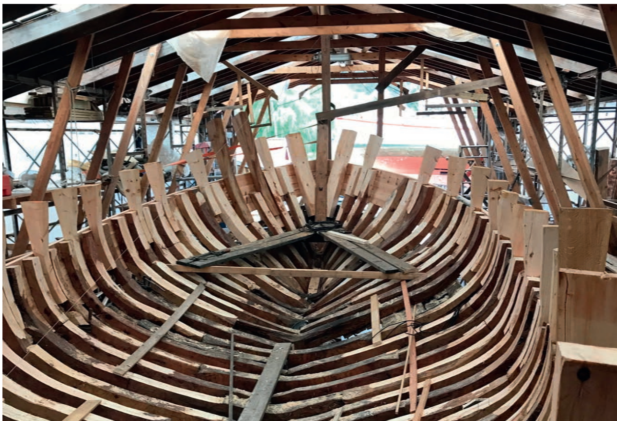
Spantene er supplert. På utsiden av de gamle spantene er det hakk for den opprinnelige klinkhuden. Foto via Hardanger fartøyvernssenter
