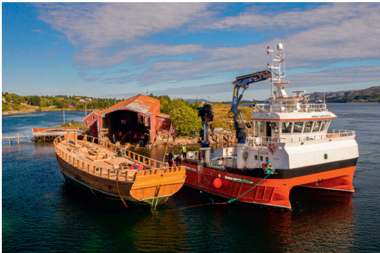
Skuta flyter, takket være presenningen vi ser under vannlinjen. Foto: via Peter Brennvik
