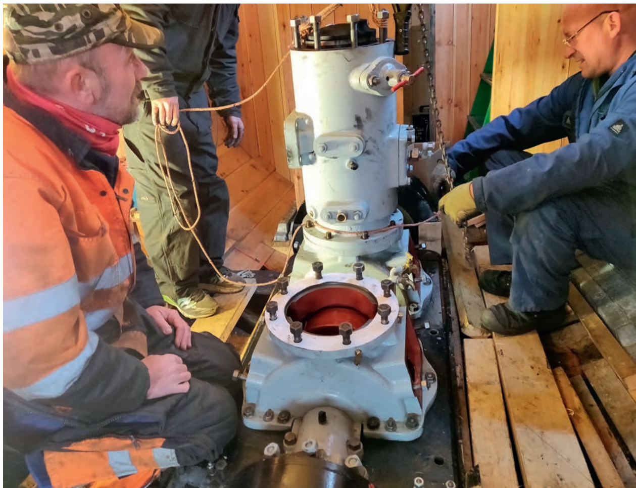
Montering av den originale Rubben. Foto: via Veteranbåtlaget Stangfjord.
