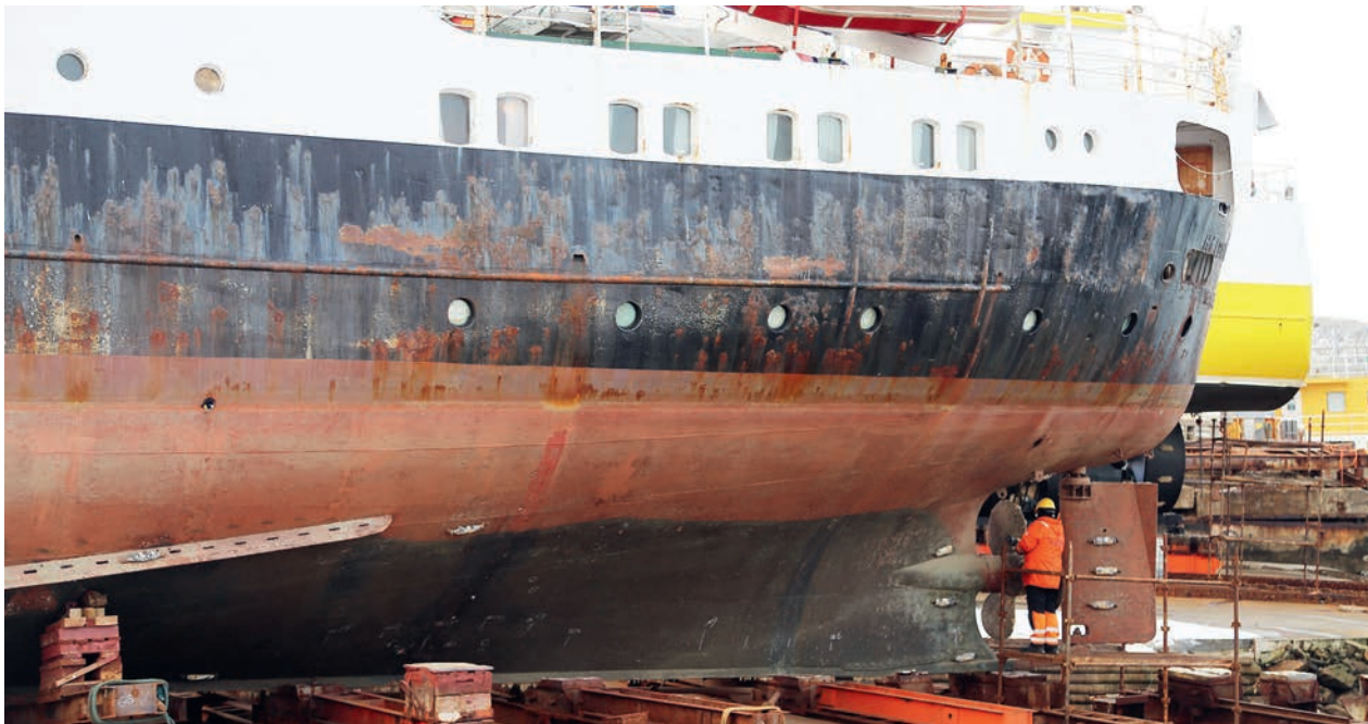
Arbeidet med å få løs propellen var svært vanskelig, da propellakslingen var rustet fast i hylsa. Foto: Trond Carlsen
