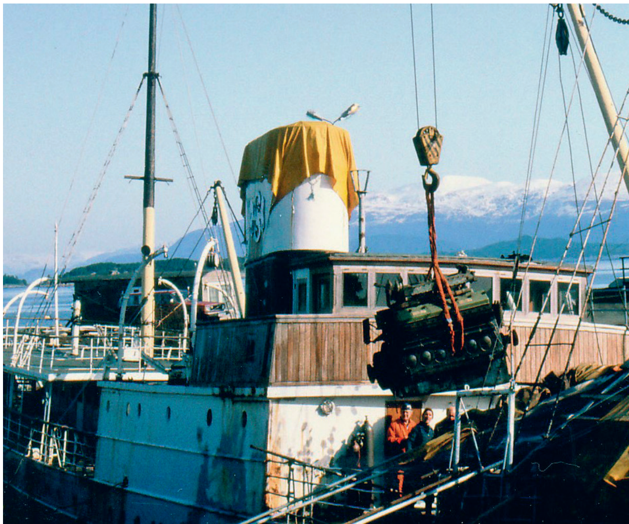
Så tok kvardagen til. Dei mangla ikkje optimisme og tru på resultatet, dei som tok til med dugnadsarbeid om bord. Her er det den eine Paxman Ricardomotoren som vert heist i land ved Stord Verft. Foto Harald Sætre.
