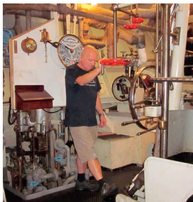
Hva er turtallet? Maskinist Arian Midthassel holder en fot mot den bevegelige eksenterstangen, teller hvor mange ganger den duler mot skoen i løpet av 15 sekunder, ganger med fire, og får dermed turtallet.
