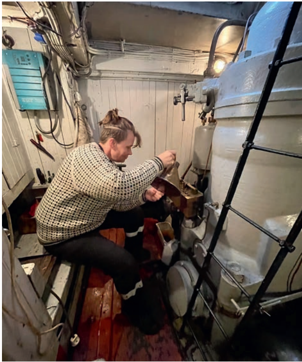
Mat skal dem ha, synger Ole Paus. Maskinist Bente Grude Borgos serverer smøreolje til motoren om bord, en 50 Hk Wichmann fra 1938, en-sylindret, to-takter semi-diesel.
