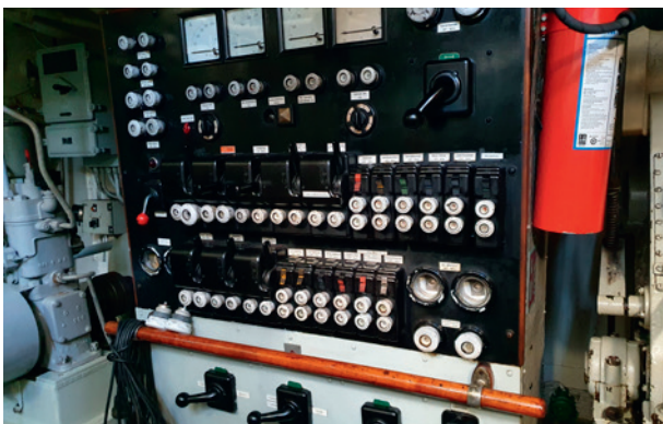
Hovedtavlen i maskinrommet til «Skilsø» er identisk med den i «Vulcanus», og gull når vi en dag trenger deler.
