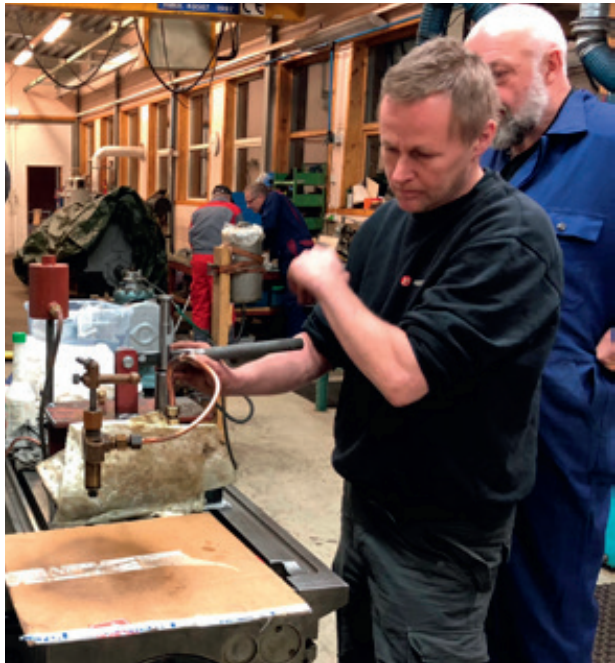
Innføring i dysetesting ved brennstoffkurs ved fartøyvern-senteret i Gratangen. Justering av dysen påvirker forbruket av drivstoff. Foto: Ronny Grindstein
