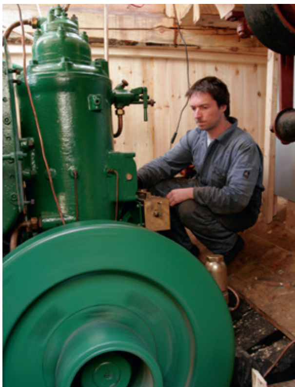
Prøvekjøring av en overhølt motor. Er det noen ulyder eller lekkasjer, hva med overflødig smørelje?
