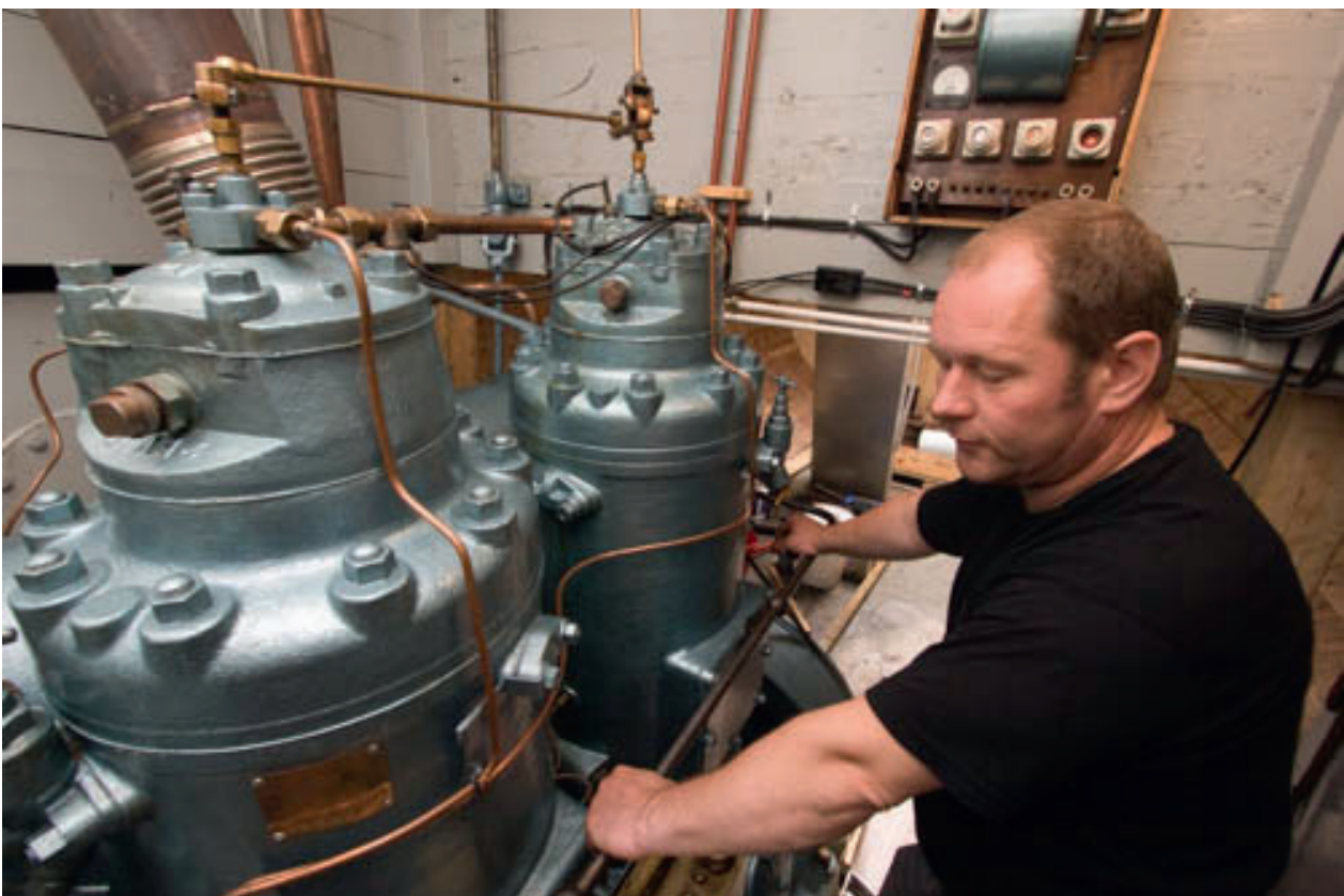
Prøvekjøring av en overhølt motor. Er det noen ulyder eller lekkasjer? Det samme prøves når motoren er montert, dessuten: Hvordan ta hånd om utlekket drivstoff, smørelje og gamle oljefiller? Foto: Arne-Terje Sæther
