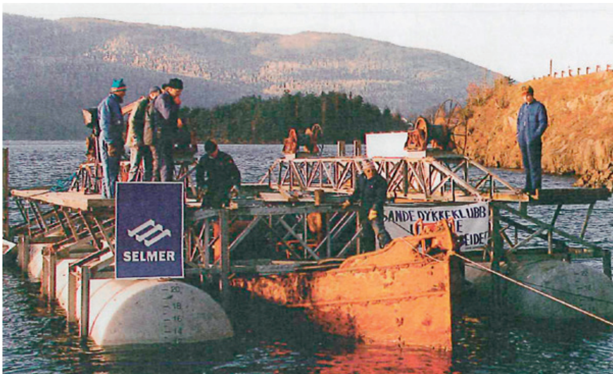
Her er skroget oppunder hevingsriggen. Den videre utfordringen blir å få skroget i riktig posisjon over slippvogna. Foto via Fred Nordseth
